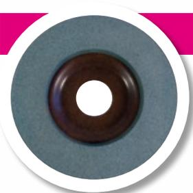
Schleifteller zum Polieren und Feinstschleifen im Trockenschliff. Anwendungsgebiete: Feinstentgraten, Effektschleifen, Abziehen oder Nachschleifen, Verrunden von Kanten, Entfernen von Anlauffarben auf CrNi-Stahl. Belag: spezielle PU-Mischung mit Schleifkorn. **Regelbare Winkelschleifmaschine erforderlich!**
